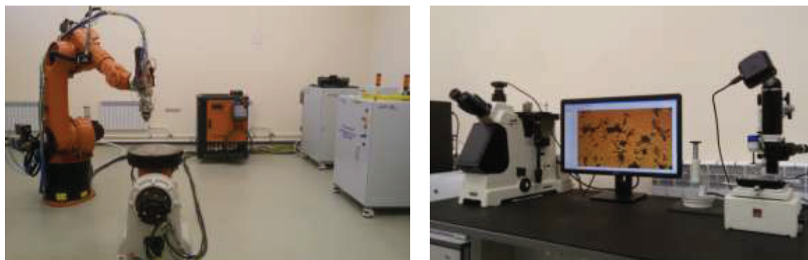
Рис. 2 – Внешний вид лабораторного роботизированного технологического комплекса «лазерной сварки» и «лазерной порошковой наплавки» а – промышленный робот KUKA KR 30 HA, волоконный лазер ЛС-1-К, оптическая головка сварочная IPGP FLW-D50, б – металлографический микроскопе МЕТАМ ЛВ-41 и микротвёрдомер ПМТ-3М
