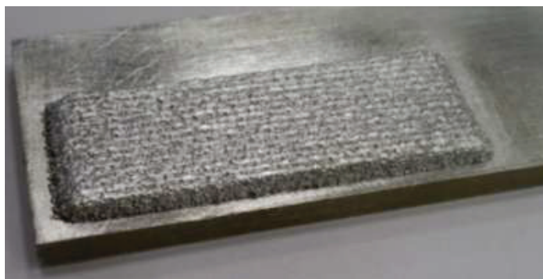
Рис. 8 – Внешний вид объемного образца, полученного методом лазерной порошковой наплавки из порошка чистого магния Особенности структуро- и формообразования объемного образца (рисунок 8).
