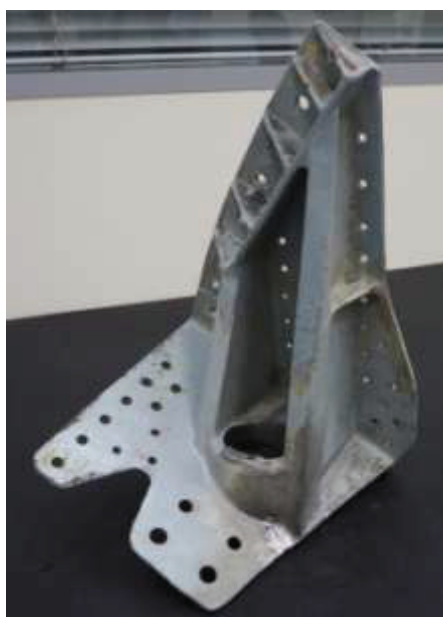
Рис. 12 – Внешний вид кронштейна № 81.0318.1001.900 навески ООШ
