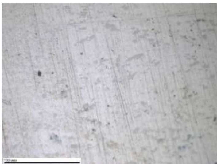
Рис. 11 – Оптическое изображение микроструктуры в переходной области между материалом сварного шва (слева) и основой (справа) – алюминиевым сплавом АК4–1Ч
